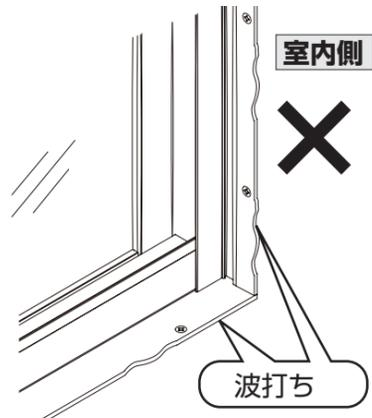
1. 下げ振り、水準器などを使用し、枠のソリ・対角差・ねじれを確認しながら枠をねじで固定してください。
