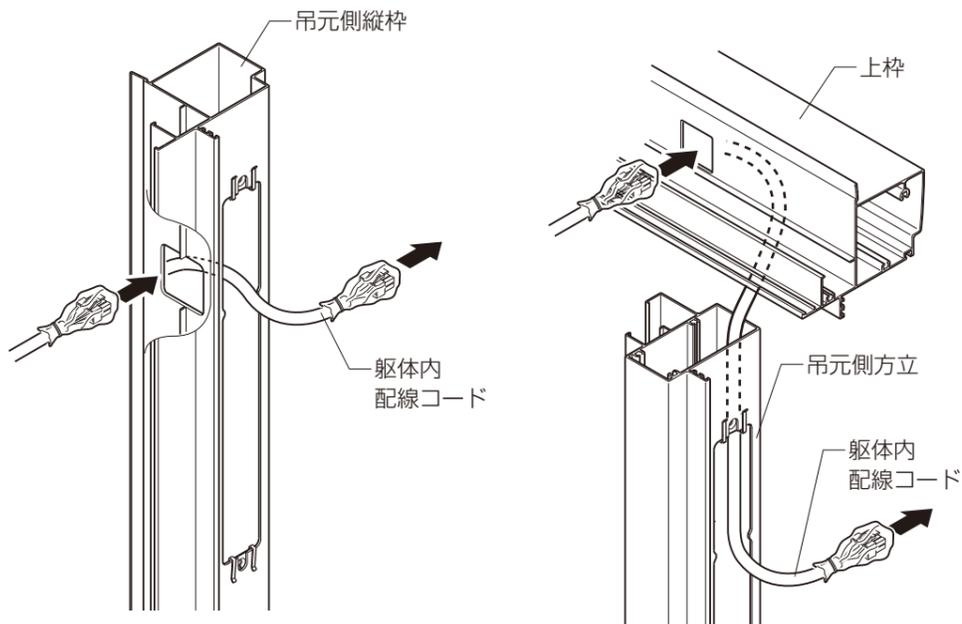
② コネクタを非接触給電（送電ユニット）に接続します。
