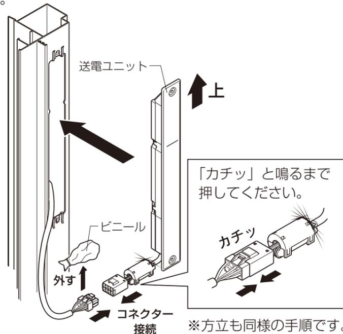
③ 非接触給電（送電ユニット）を枠に取付けてください。
